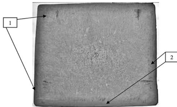
Рисунок 3 — Макроструктура НЛЗ с ЛП, перпендикулярными граням (1) в районе углов и перпендикулярными граням в средней их части (2)
