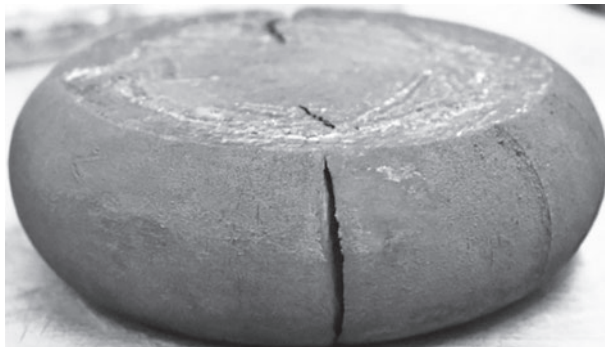
Рисунок 14 — Проба с ЛП угловыми длиной 20 мм после осадки на 2/3 высоты: a — торец пробы; б — макроструктура; в — поверхность
