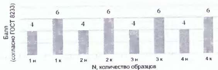
Рис. 4. Дисперсность перлита в подповерхностном слое бунтового проката диаметром 16,5 мм согласно ГОСТ 8233 (стандартный режим охлаждения)
