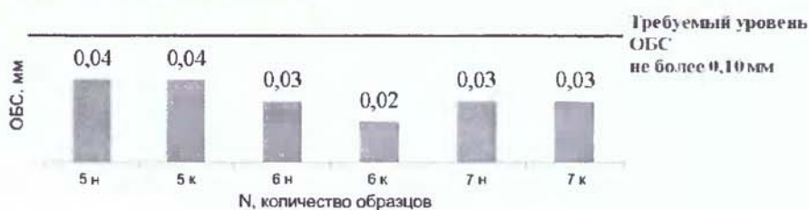
Рис. 14. Величина обезуглероженого слоя в бунтовом прокате диаметром 16,5 мм согласно ГОСТ 1763 после сфероидизирующего отжига (экспериментальный режим охлаждения)
