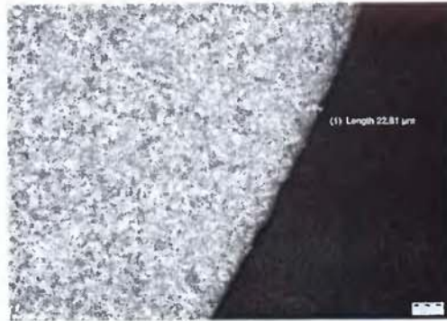
Рис. 7. Обезуглероживший слой горячекатаного образца буитового проката (стандартный режим охлаждения), \times 100
