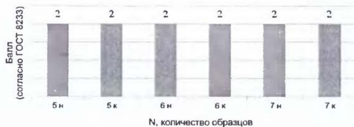
Рис. 12. Дисперсность перлита бунтового проката диаметром 16,5 мм согласно ГОСТ 8233 (экспериментальный режим охлаждения)
