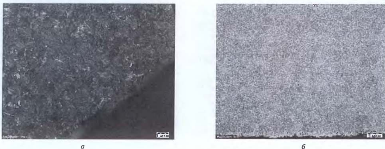
Рис. 5. Микроструктура катанки диаметром 6,5 мм (III этап):
