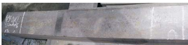
Рис. 1. Внешний вид выделенного блюма с поперечными трещинами на одной из больших граней
