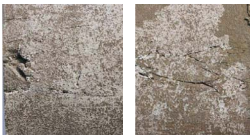
Рис. 6. Внешний вид дефектов поверхности проката (расположение дефекта соответствует ребру НЛЗ)
