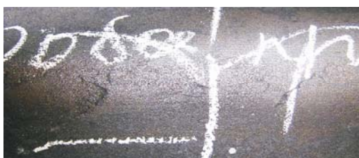
Рис. 5. Внешний вид дефектов поверхности проката (расположение дефекта соответствует одной из больших граней НЛЗ)
