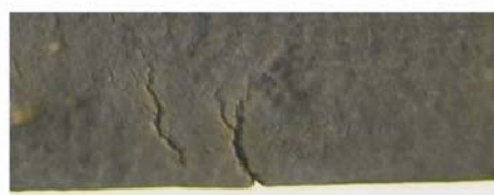
Рис. 3. Поперечные трещины на ребрах НЛЗ: а — после дробеструйной обработки поверхности; б — после удаления поверхностной окалины травлением
