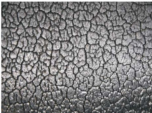
Рис. 1. Сетка разгара на чугунных валках
