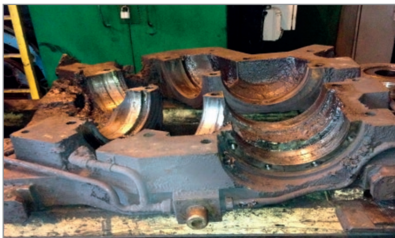
Рис. 1. Полу корпус клетки 330 трубопрокатного редуционно-растяжного стана
