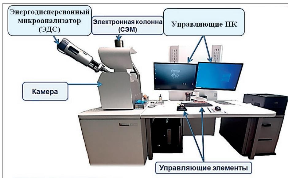
Рис. 2. Исследовательский комплекс – сканирующий электронный микроскоп TESCAN VEGA GMS с энергодисперсионным микроанализатором AztecLive Automated Ultim Max 65
