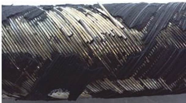
Рис. 8. Разрушение проволоки на боковой поверхности предоставленного фрагмента
