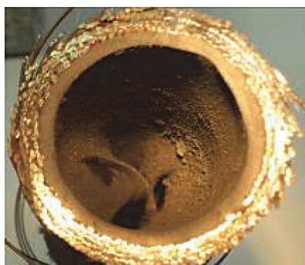
Рис. 6. Разрушения на внутренней камере
