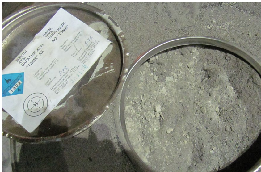
Рис. 3. Вид материала после хранения в упаковке с нарушенной герметичностью
