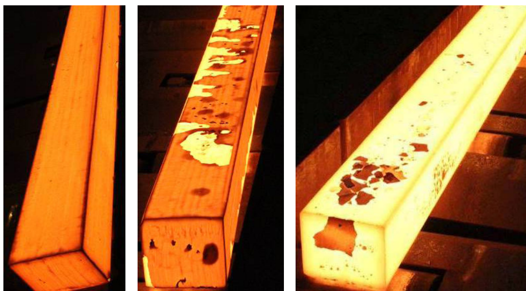
Рис. 4. Внешний вид непрерывнолитой заготовки после нагрева перед деформацией: а – отключена установка гидросбива; б – неудовлетворительная работа установки гидросбива; в – удовлетворительная работа установки гидросбива
