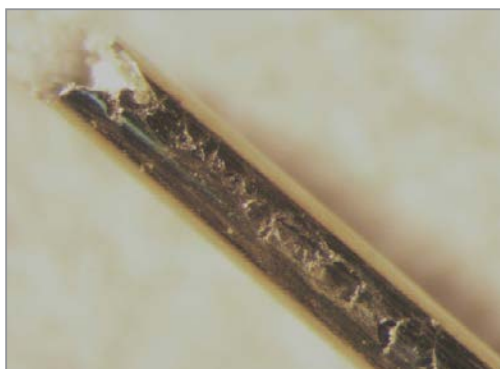
Рис. 1. Внешний вид хрупкого разрушения по поверхностным трещинам. x25
