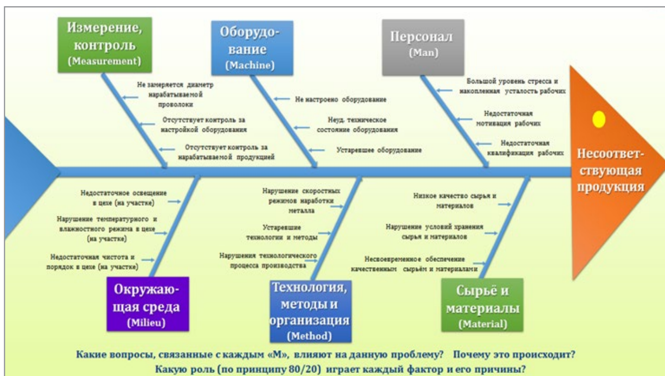
Рис. 1. Пример модели Исикавы или метод 6М
