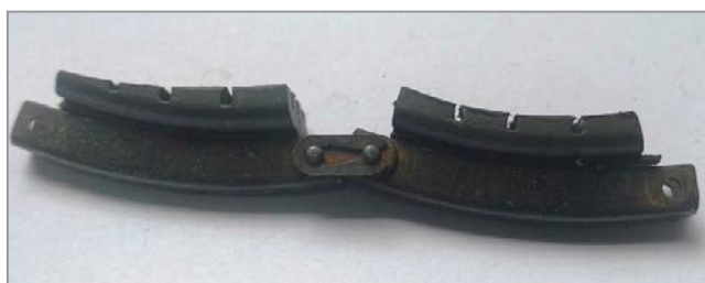
Рис. 2. Сравнение конструкций серийных и модернизированных тормозных цепочек: а – элементы серийной цепочки; б – элементы цепочки нового типа
