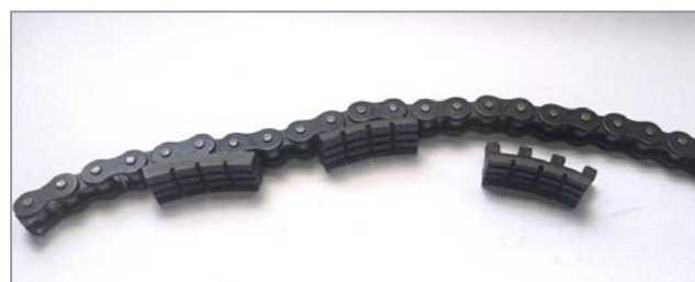
Рис. 2. Сравнение конструкций серийных и модернизированных тормозных цепочек: а – элементы серийной цепочки; б – элементы цепочки нового типа
