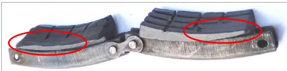
Рис. 1. Состояние износа тормозных колодок (серийные цепочки)
