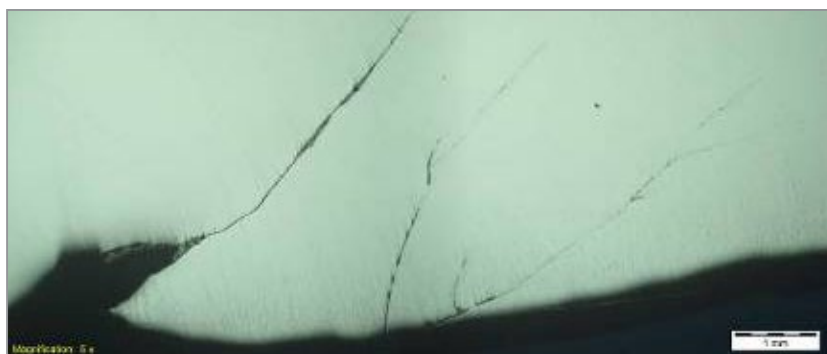
Рис. 2. Макроструктура поперечного сечения круглой горячекатаной заготовки диаметром 140 мм стали марки 18Г2АФ
