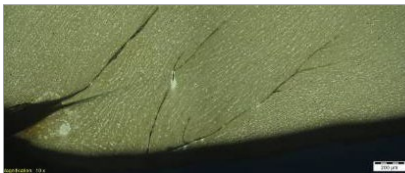
Рис. 3. Микроструктура в зоне выявленных дефектов на поверхности круглого горячекатаного проката стали марки 18Г2АФ: a – нетравленный микрошлиф; б – травление в реактиве «Nital»; в – травление в реактиве «Обергоффера». х 100
