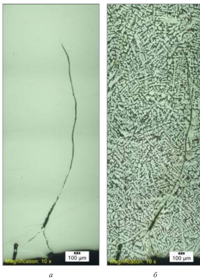
Рис. 6. Выявленные дефекты на непрерывнолитой заготовке сечением 300x400 мм стали марки 18Г2АФ: а – нетравленный микрошлиф; б – травление в реактиве «Nital». x100
