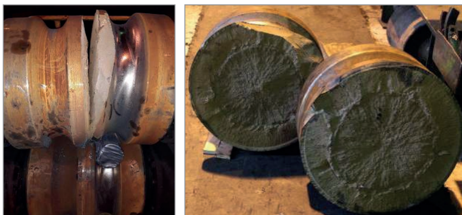
Рис. 1. Внешний вид разрушенного валка и характер разрушения
