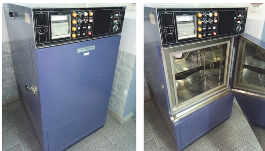
Рис. 2. Камера искусственного климата марки 2X-5655-CH
