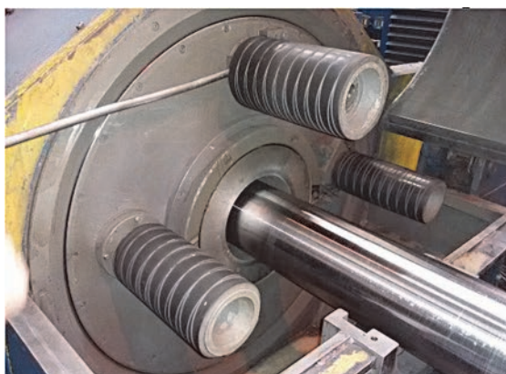
Рис. 5. Планетарный шлифовальный блок
