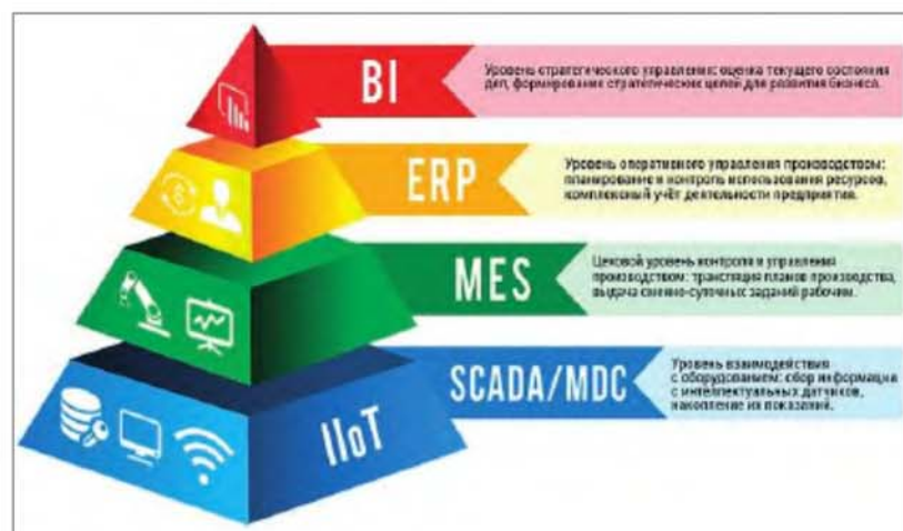
Рис. 5. Иерархические уровни автоматизации производства [8]:
