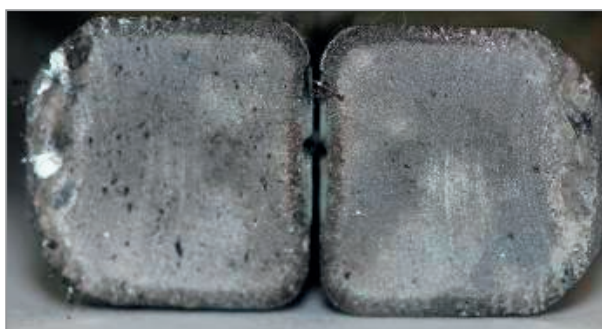
Рис. 2. Внешний вид излома звена цепи
