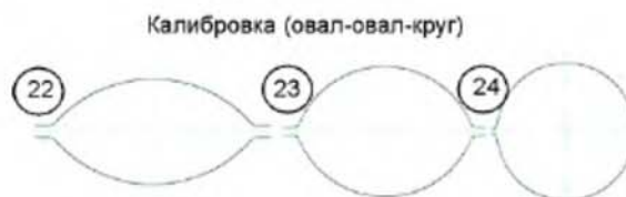
Рис. 1. Упрощенная схема калибровки РКБ по схеме овал–овал–круг
