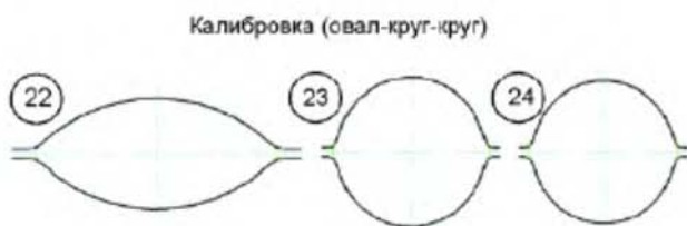
Рис. 6. Упрощенная схема калибровки РКБ по схеме овал-круг-круг
