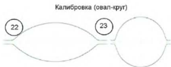
Рис. 2. Упрощенная схема калибровки РКБ по схеме овал-круг
