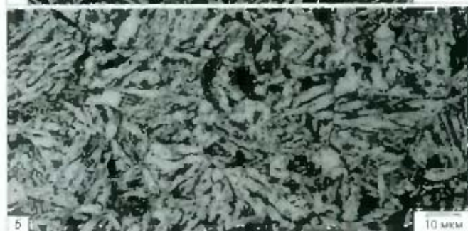
Рис. 2. Микроструктура образца круга diam. 45 мм стали 42CrMo4: а – основная структура; б – светлый контур. \times 1000
