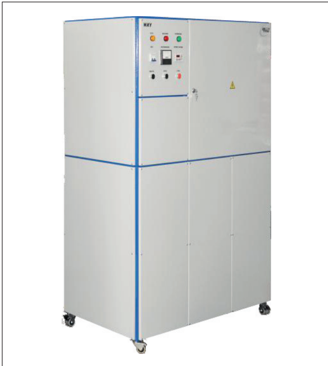
Рис. 2. Установка МИП-18 с запасаемой энергией 15 кДж
