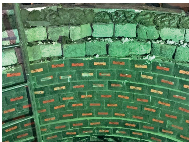
Рис. 2. Фотография футеровки сталеразливочного ковша, последние ряды которого выполнены изделиями, бывшими ранее в эксплуатации
