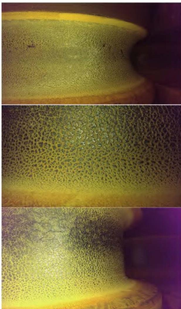
Рис. 3. Валки черновой группы клетей с сеткой разгара на поверхности бруса при различных коэффициентах трения
